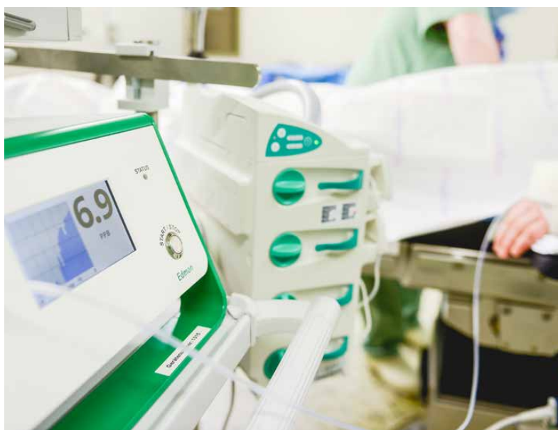
Der Exhaled Drug Monitor / EDMON zeigt die Propofol-Konzentration in der Ausatemluft des Patienten an
