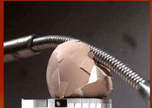
Simulation des Bruchlinienverlaufes bei Schlagelwirkung.
