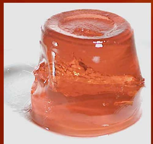
Modellierung der Wundballistik. Gelatine wird, im Bild von links nach rechts, von einem ‚Softair‘-Projektile durchschlagen. Es bildet sich ein temporärer Schusskanal aus dem Einschuss wird Material herausgeschleudert.
