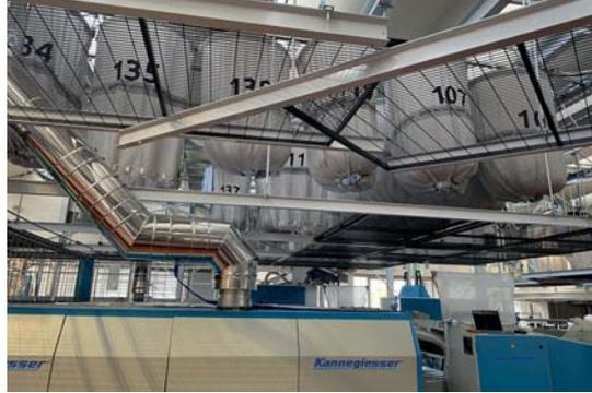
*Wäschespeicher der „reinen Seite“ über der Kleinteileman- gel: Abgepackt in große Säcke geht die Wäsche nach dem Waschvorgang über ein Förderband an der Decke zur Man- gel oder zum Tunnelfinisher*
